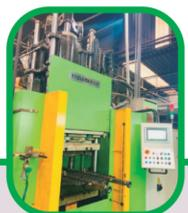
Machines de moulage par injection à haute productivité, avec une capacité d'injection allant jusqu'à 2 000 mm<sup>3</sup> de caoutchouc, un plateau de 600x650 mm, avec un système d'injection multipoint, assurant une plus grande performance et moins de perte dans le processus.
